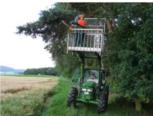
*Arbeitskorb mit einer Geländerhöhe von 1 Meter und einer Holzauflage auf dem Handlauf.*
