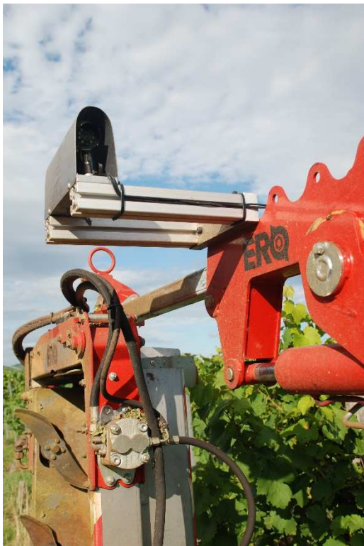
Unter dieser Schutzhaube sind die Kameras montiert
