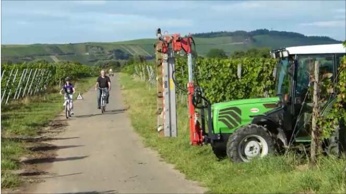
Die laufenden Messerkreisel ragen schon in die Fahrbahn, der Fahrer hat aber noch keine Einsicht in den Weg
