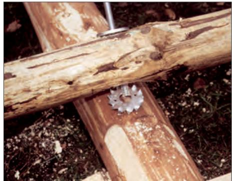
Mit einem leistungsstarken Akku-Bohrschrauber und geeigneten Bohrern, wie z. B. Schlangenbohrern (obenliegend) und Schalungsbohrern, kann man auch dickere Hölzer bearbeiten.
