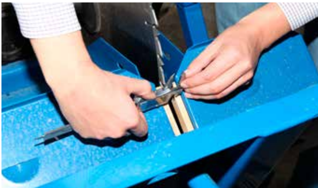
Baumusterprüfungen von Kreissägen erfordern unter anderem die korrekte Messung von Abständen
