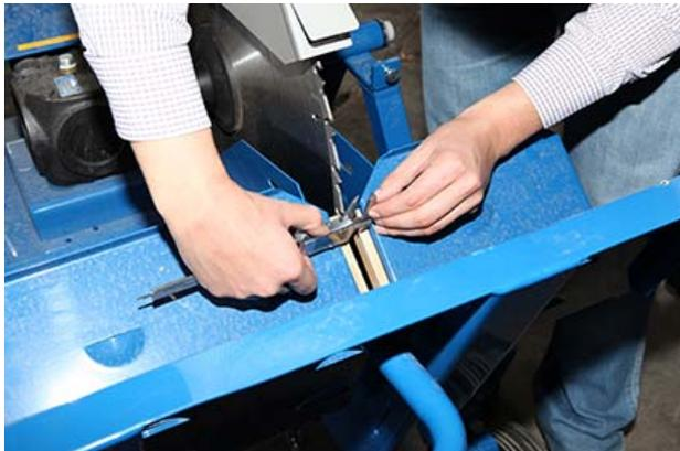
Baumusterprüfungen von Sägen erfordern u. a. die korrekte Messung von Abständen.
