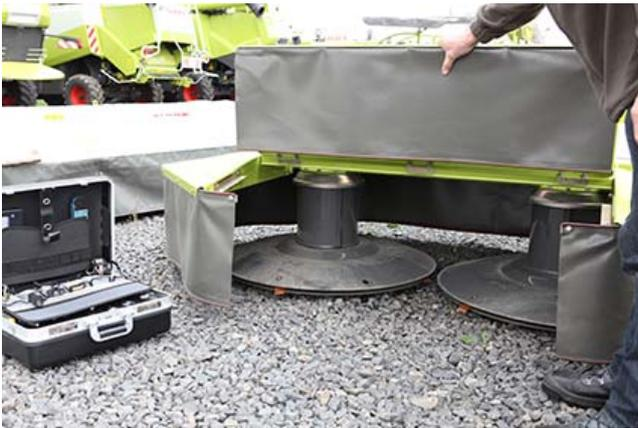
*Die Arbeitssicherheitsprüfung umfasst nicht nur den Schutz des Bedieners der Maschine, sondern berücksichtigt auch den Schutz von Dritten, wie zum Beispiel die Gefahr durch herumfliegende Steine bei Mähwerken.*
