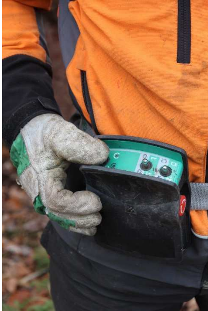
Funkfernbedienung der Personen-Notsignal-Anlage (PNA) am Gürtel
