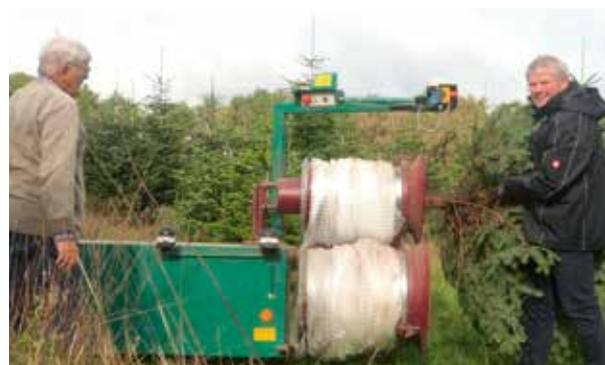
An der Netzmaschine muss enganliegende Kleidung getragen werden, die nicht eingezogen werden kann.
