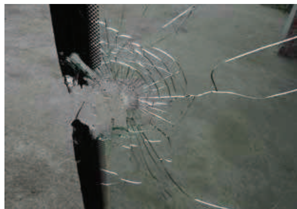
Ein Geschoss durchschlug diese Frontscheibe eines Feldhäckslers bei der Jagd am Mais. Es blieb glücklicherweise in der Armlehne stecken.
