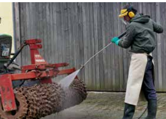
Gehörschutz kombiniert mit Gesichtsschutz bei Reinigungsarbeiten
