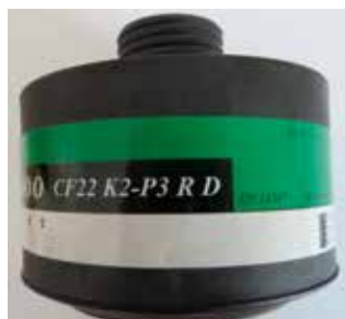
Kombinationsfilter mit Schutzwirkung gegen - Ammoniak (grüne Bänderung, Typ: K) und - Staub (weiße Bänderung, Typ: P)
