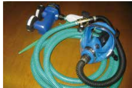
Frishluftschlauchgerät z. B. beim Einstieg in die Güllegrube
