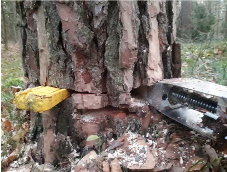
Abb. 2: Das unterschrittene Stützband verhindert den Kontakt Der Sägekette mit den eingesetzten Keilen.
