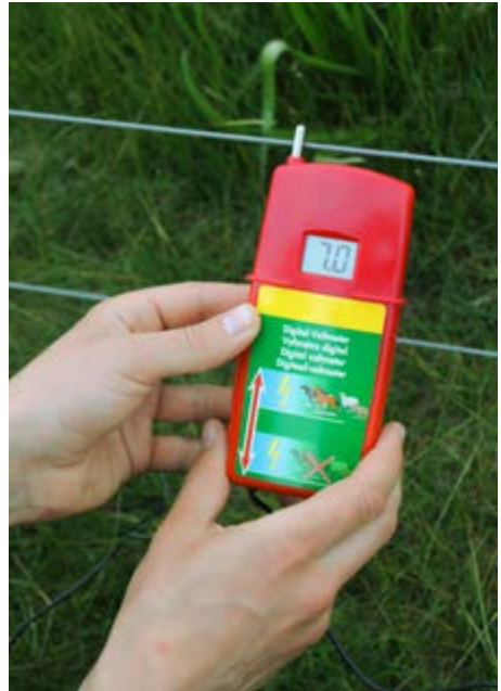
Digital-Voltmeter zur Messung der Hütесpannung.
