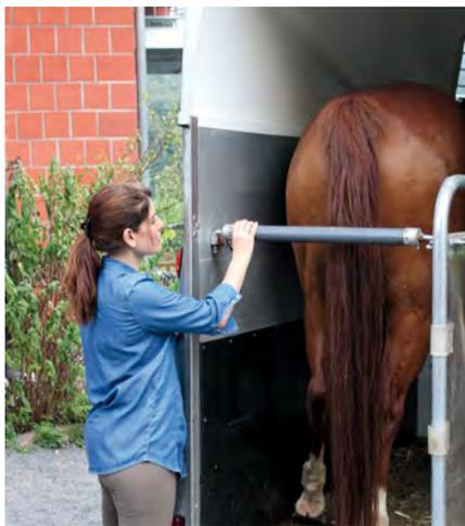
Beim Schließen/Öffnen der Heckstange seitlich stehen
