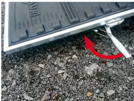
Verdecken des Heckklappenverschlusses
