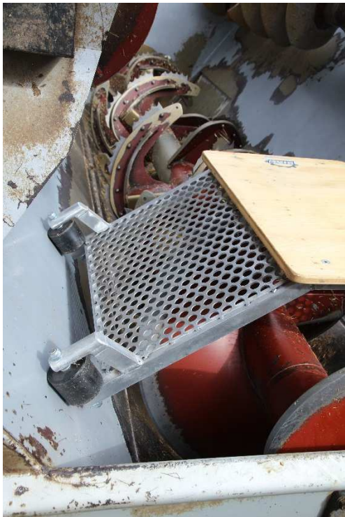
Montagewagen im Futtermischwagen (Draufsicht)
