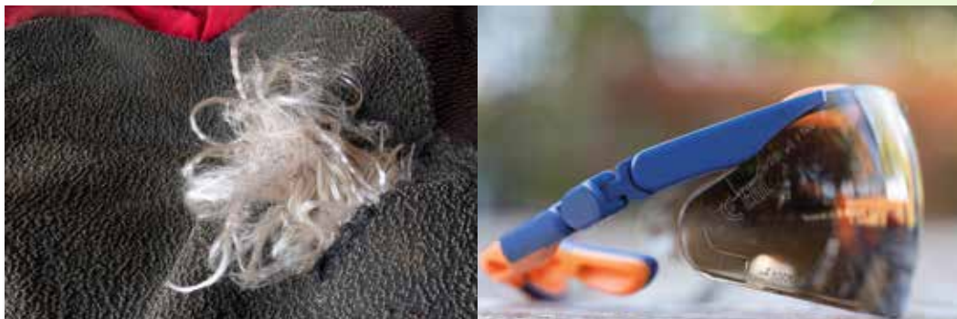
links: Schnittschutzfasern werden bei Kontakt mit der Sägekette herausgezogen und bringen sie zum Stillstand. rechts: Geeignete Brillen schützen vor schädlicher UV-Strahlung.
