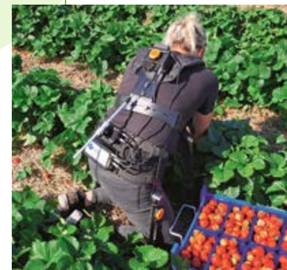
Beispiel einer Messung der Kniebelastung bei der Erdbeerernte
