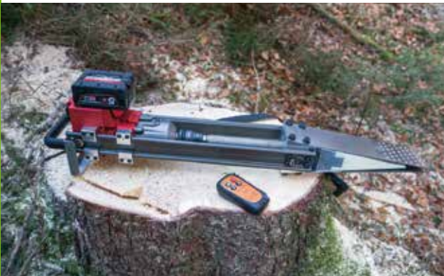
Mechanisch – Akkuantrieb mit Spindel
