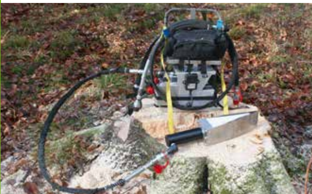
Hydraulisch – Pumpe mit Hydraulikzylinder
